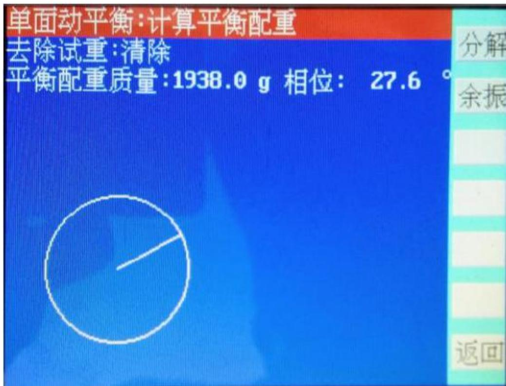
根据配重结论 取下试重 在相应的相位焊接配重
